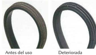
**Si se deteriora:** Si la correa se rompe, se presentarán problemas como que se descargue la batería. Si la correa se rompe debido al uso sin ajustar la tensión o sin reemplazo, el motor podría sobrecalentarse, la batería podría agotarse o el motor podría detenerse.
