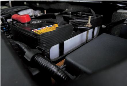
La batería es la fuente de poder que enciende el motor y suministra energía a los equipos dentro del vehículo.
