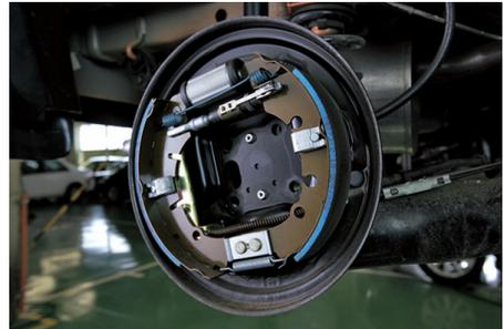
Las bandas presionan las campanas de freno desde el interior reduciendo la velocidad del vehículo mediante fricción. / Cuando pisa el pedal de freno, el líquido de frenos transfiere la fuerza a los frenos.
