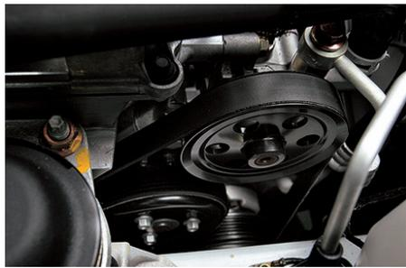
Las correas transfieren la potencia del motor a otros elementos para activar su funcionamiento.
