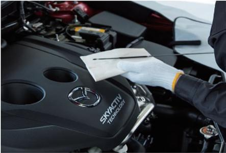
El aceite lubrica el interior del motor. / El filtro de aceite limpia el aceite de motor.
