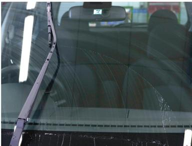
Partes sin limpiar debido a limpiaparabrisas deteriorados
