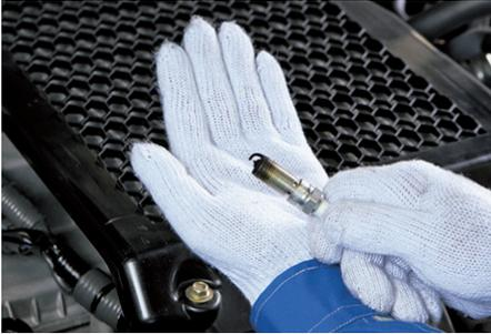
Las bujías generan la chispa que enciende la mezcla de aire-combustible inyectada en el motor.
